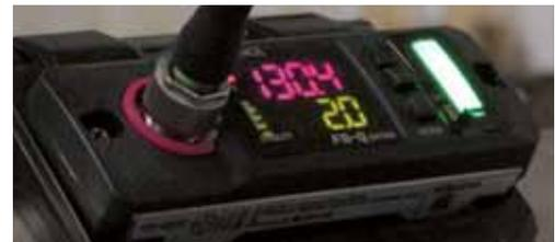
Zusätzlich zur Anzeige im Temperiergeräte-Display: Darstellung der Durchflussmenge und des Status am Sensor
