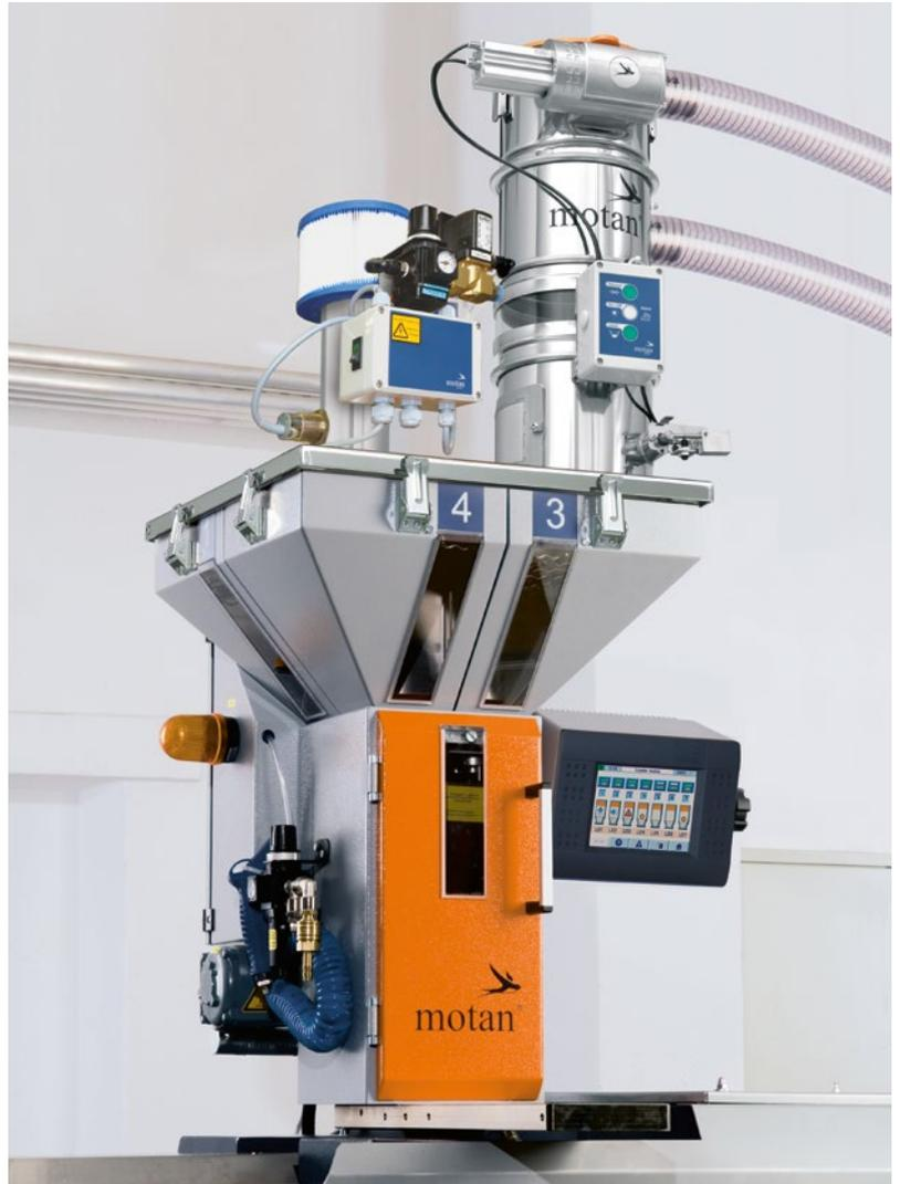
motan GRAVICOLOR Geräte dosieren und mischen bis zu vier Materialien präzise und mit höchster Rezeptgenauigkeit. Diese modularen, gravimetrischen Dosier- und Mischgeräte sind speziell für den Bereich des Spritzgießens, des Blasformens und der Extrusion konzipiert, mit Durchsatzleistungen bis 150 kg/h.
