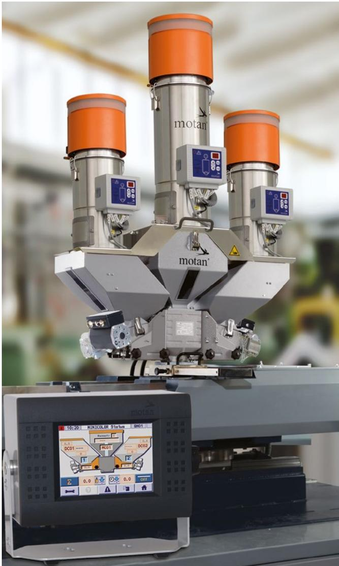
Das MINICOLOR G ermöglicht die einfache Zudosierung von Mahlgut. Dank der automatischen Kalibrierung ist die Inbetriebnahmezeit sehr gering. Das Gerät ist vibrationsunempfindlich und speziell für den Aufbau auf den Schneckeneinzug der Verarbeitungsmaschine bestimmt.
