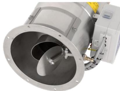
Dank des Schwenckdeckels können Geräte und Filter unkompliziert gereinigt werden. Eine konstante, zuverlässige Förderung wird außerdem durch eine automatische Filterreinigung mit Druckluft nach jedem Förderzyklus gewährleistet.
