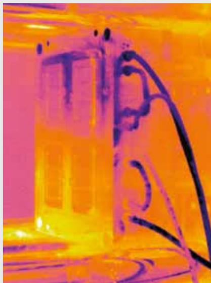
*Inhomogene Temperaturverteilung im Spritzgießwerkzeug durch verschmutzte Temperierkreisläufe.*
