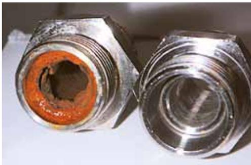
Produktivität erhöhen durch Reinigung und Schutz der Temperierkanäle
