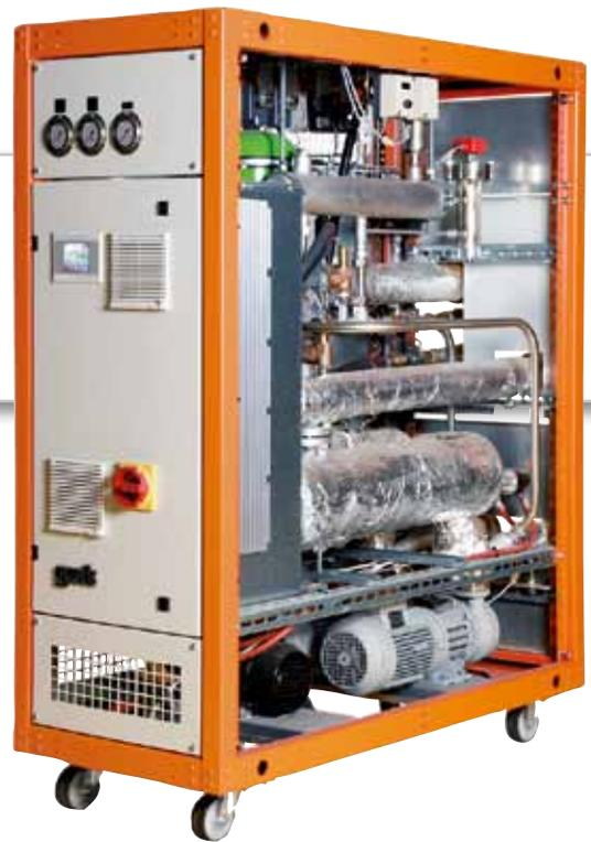
Eine ausgereifte Gerätetechnik macht den drucküberlagerten Betrieb mit Wasser bis 200 °C sicher.
