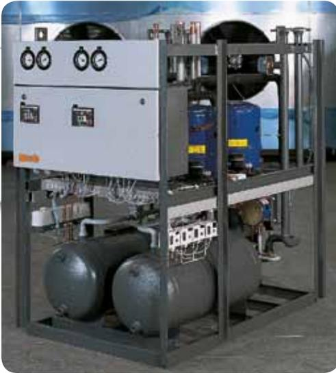
Kompaktkältemaschine mit zwei getrennt regelbaren Kühlkreisläufen
