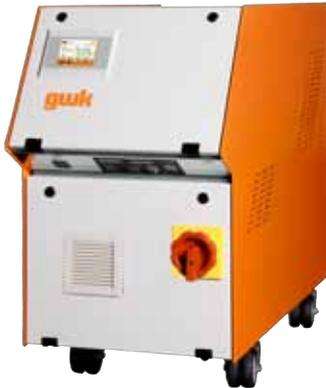
Das **gwk**-Temperiergerät der Typenreihe **teco cs 230t 9** ist ein anschlussfertiges Heiz- und Kühlgerät mit indirekter Kühlung, welches für den Betrieb mit Wasser als Umlaufmedium konzipiert ist. Der als geschlossenes System mit automatischer Drucküberlagerung ausgeführte Wasserkreislauf erlaubt einen sicheren Einsatz bis 225 °C.
