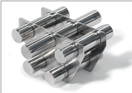
Preislich günstiges Primärmagnetsystem, das z.B. in den Materialtrichter einer Kunststoff-verarbeitenden Maschine eingelegt wird und durch die Abscheidung von größeren Eisenmetallteilchen für eine erhebliche Qualitätsverbesserung des Produktes und zur Vermeidung teurer Reparaturen dient.
