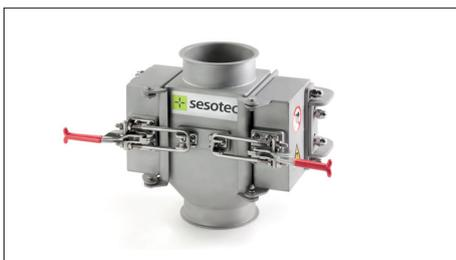
Magnetsystem für den Einsatz bei leicht "brückenbildenden" sowie bei faserigen Produkten, das sich bei sehr großen Durchsatzleistungen und Rohrleitungen bewährt hat und zur leichteren Abreinigung der Magnetblöcke mit abschwenkbaren Edelstahlplatten ausgestattet ist.
