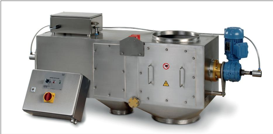
Der rotierende Magnetabscheider ROTOBOX AUTO CLEAN wird hauptsächlich eingesetzt, um feine und feinste Fe-Verunreinigungen aus Schüttgütern, welche zur Brückenbildung bzw. zum Anbacken neigen, vollautomatisch zu separieren. Die mittels eines Elektromotor angetriebene Magnetstabmatrix verhindert
