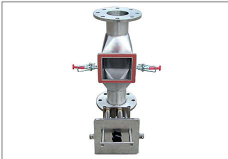
Der Rohrmagnet MAGBOX wird hauptsächlich in (bereits vorhandenen) Rohrleitungen zur gründlichen Separation von feinen und feinsten Eisenmetallverunreinigungen aus Schüttgütern eingesetzt. Die optionale EASY CLEAN Abreinigung erlaubt eine effektive und schnelle Reinigung des Abscheiders.
