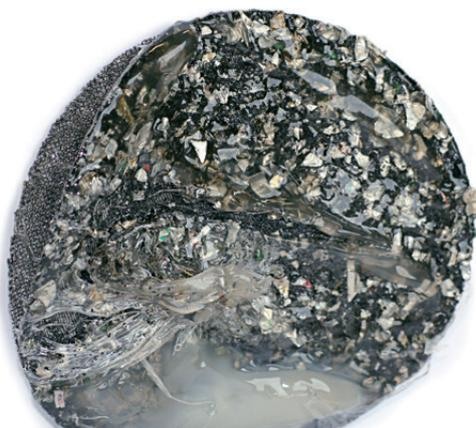
Schmelzefilter mit konventioneller Metallabscheidung nach 4 Stunden im Einsatz
