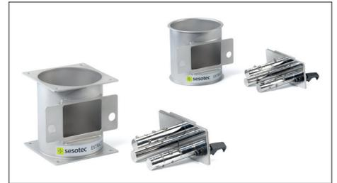
Magnet-Separator für höhere Materialdurchsätze, größere Nennweiten (40 - 150 mm) und Korngrößen (8 - 10 mm), der am Einzug der Spritzgießmaschine eingebaut wird und bei erhöhter Kontamination zur Vorabscheidung von Eisenmetallen eingesetzt wird.
