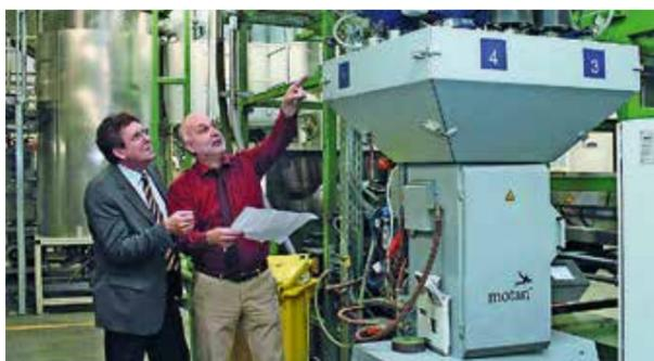
„Komponieren“ die Materialversorgung für die PET-Umreifungsbänderproduktion bei Cyklop gemeinsam: Georg Flink (l.) und Bernd Causemann an einem Dosier- und Mischgerät Gravicolor 600 mit vier Dosiereinheiten für Granulat, Flakes, Farbe und Masterbatch
