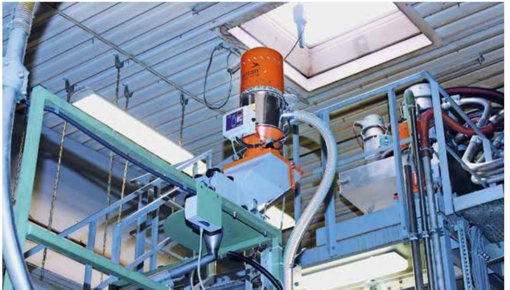
Technik bis unter die Decke 1: Dosiergerät Minicolor mit Fördergerät Metro HES 250
